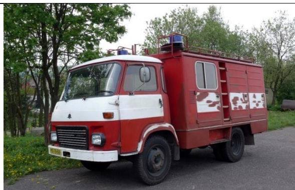
Hasičský automobil Avia již v pojezdovém stavu, před finálním dokončením karoserie
